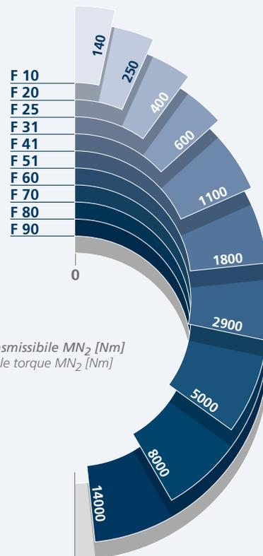
Coppia trasmissibile  $MN_2$  [Nm]
