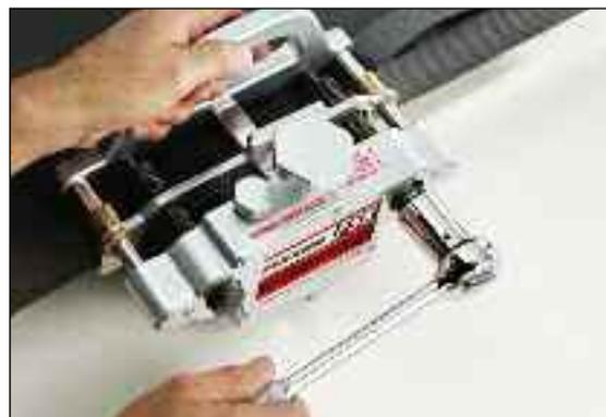
Нож для снятия части обкладки ленты FSK™ идеально подходит для тяжелого режима работы и позволяет измерить глубину выемки. Теперь качество защитной обкладки ленты не имеет значения, и результатом работы всегда будет ровный качественный стык.
