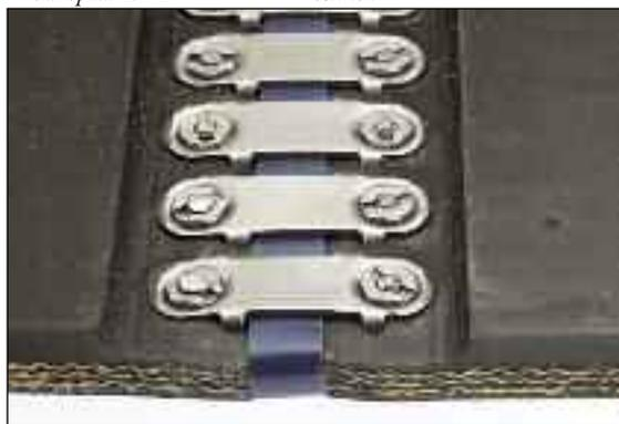
Для уменьшения ударного взаимодействия места соединения с устройствами очистки на роликах, несущих обратные ленты транспортера, крепления можно устанавливать под поверхностью ленты. Такой процесс называется снятием части обкладки. Для выполнения снятия части обкладки толщина ленты должна составлять не менее 5 мм.
