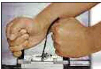
Нож для снятия части обкладки в лентах Flexco® позволяет быстро и просто выполнить отдельную выемку в ленте конвейера, что позволяет «утопить» верхнюю или нижнюю пластину соединения в поверхности ленты. Это предотвращает заклинивание и повреждение места соединения устройствами для очистки ленты.
