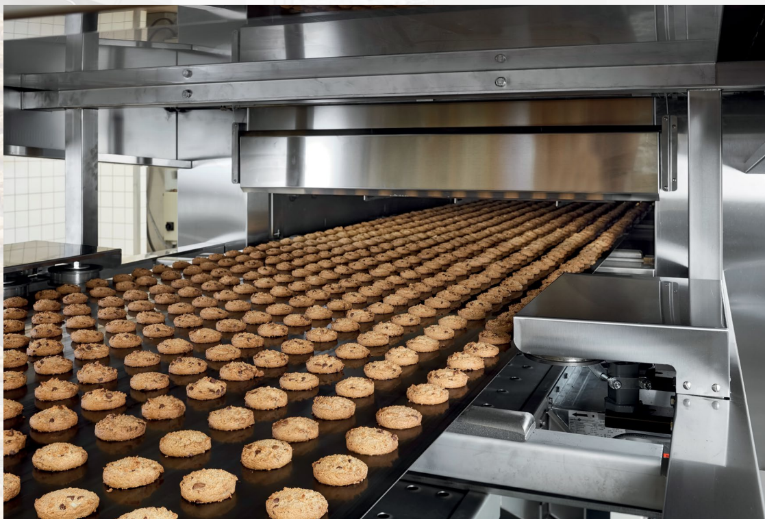
© Современная, полностью оснащенная испытательная печь компании Haas Meincke в Скволунде, Дания. Испытательная печь оснащена бесконечной лентой из стали CARBO 13 производства Berndorf Band.
