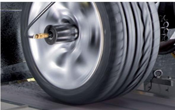
©IABG mbH — Стенд Flat-Trac для испытания шин полуплоской сборки
