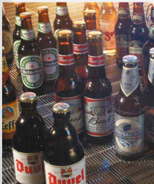
Плоская поверхность этих сеток служит устойчивым основанием и прекрасно подходит для пастеризации и т.д.
