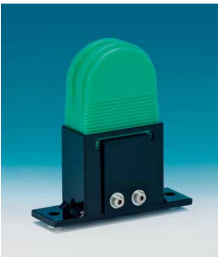
Исполнения Spann-Box® с блокировкой для предотвращения упругого прогиба профилей скольжения, например, при изменении направления вращения
