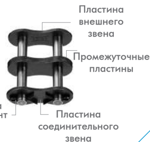
Соединительное звено со шплинтом, многорядное (изображено двухрядное)
