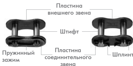
Соединительное звено с пружинным зажимом
