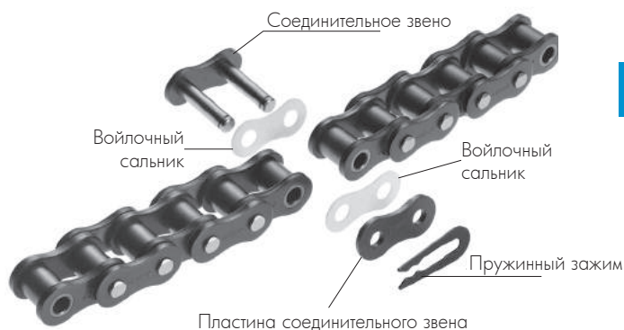
Рис. 12 Метод соединения BS X-LAMBDA
