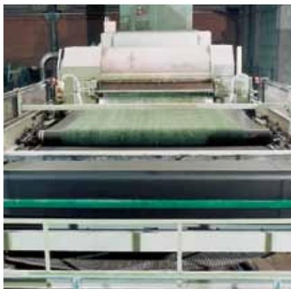
Крестоукладчик при производстве нетканых материалов. Высокая скорость производства и ускорения массы при поперечной раскладке прочеса непосредственно между двумя конвейерными лентами предъявляют к таким лентам очень высокие требования.
