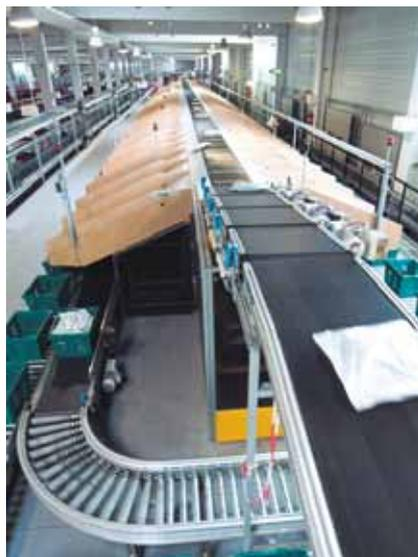
Поперечный сортировщик в распределительном центре. Сильное ускорение требует от поверхности конвейерной ленты максимально высокого коэффициента трения.
