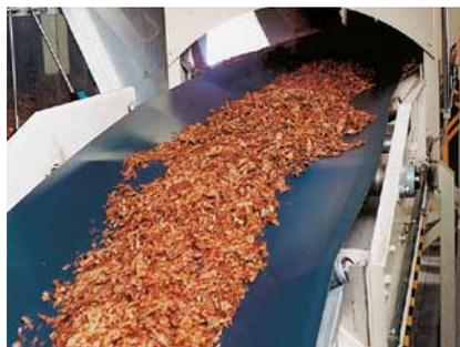
Горизонтальный конвейер с желобчатой лентой. За счет особой структуры и способности к натяжению лента обладает эластичностью в нужном направлении.
