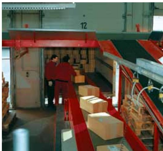
Ленты телескопических конвейеров – на данной иллюстрации используемые для разгрузки грузовика – должны выдерживать встречный изгиб при очень высоких точечных нагрузках.
