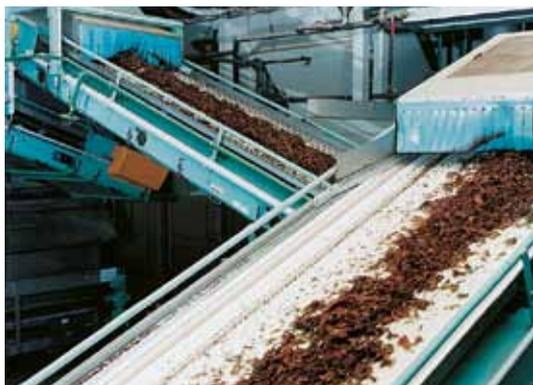
Наклонный конвейер в табачной промышленности. В этой отрасли угол наклона может достигать 22° при использовании конвейерных лент с гладкой поверхностью.
