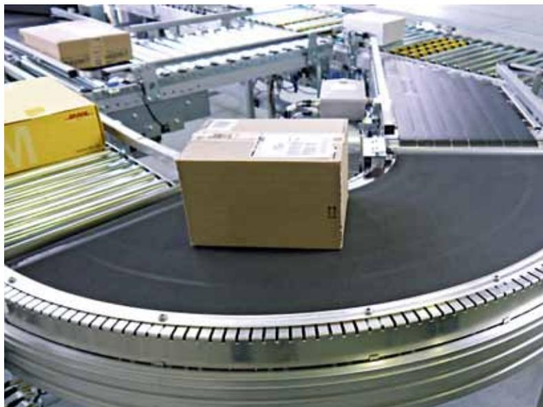
Криволинейный конвейер в распределительном центре
