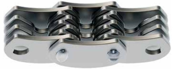
PennPower – высокотехнологичная бесшумная цепь для силовой передачи. Специальная разработка компании Пеннайн Индастриэл. Силовые Цепи PennPower имеют КПД в два раза больше чем стандартные цепи 'SC' и работают на таких же звездочках. Цепи PennPower обычно находят применение где высокие нагрузки и скорости ограничены малым пространством. Производятся с шагом 3/8" и 1/2" и шириной до 6". На заметку: Звездочки к Цепям PennPower должны иметь не менее 21 зуба.
