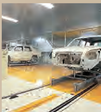
Конвейерные системы для автомобильных линий покраски
