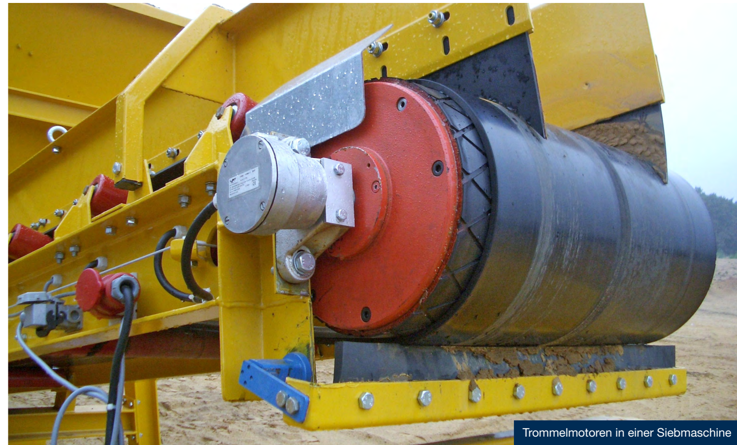
Trommelmotoren in einer Siebmaschine
