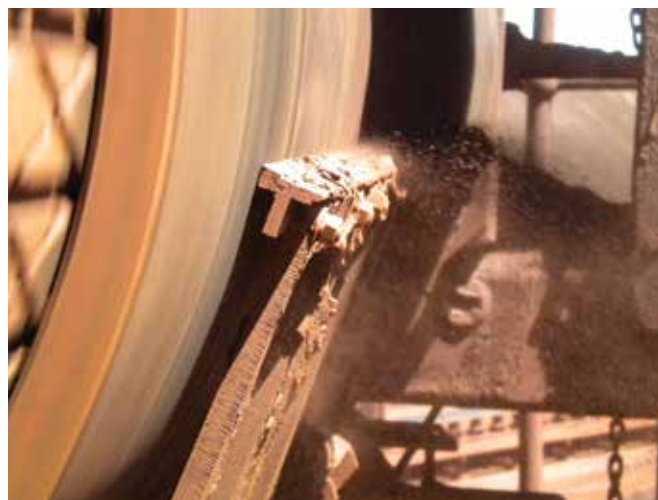
На рисунке: устройство для предварительной очистки H-Tуре с наконечниками V
