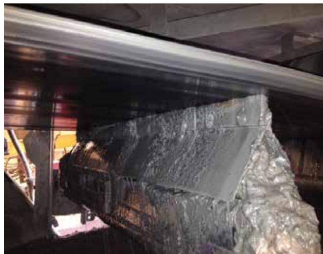
На рисунке: устройство для вторичной очистки MHS HD
