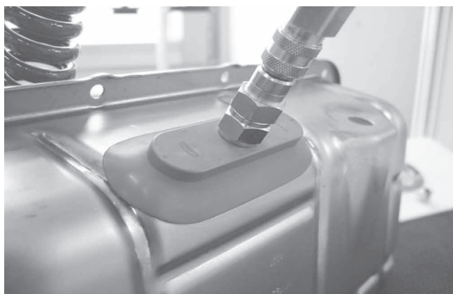
Конусная вакуумная присоска SAOG для подъема очень изогнутых деталей из листового металла
