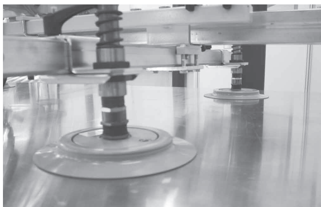
Присоска SPU, установленная на управляемое вручную подъемное устройство
