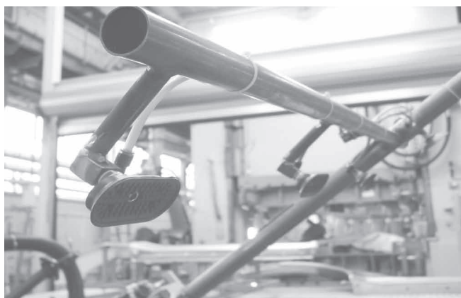
Плоская вакуумная присоска SAOF для подъема изготовленных прессованием частей из листового металла
