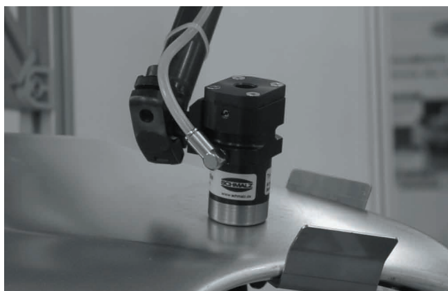
Устройство типа «паук» с магнитным захватом SGM 34 для манипулирования металлическими листами
