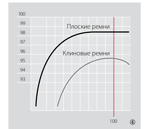
Эффективность плоского ремня (вверху) Эффективность клинового ремня (внизу) Плоские ремни Siegling Extremultus имеют КПД = 98,6%
